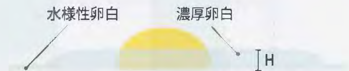
図 6-6 平板に割卵した卵を横から見た図 濃厚卵白の中央部の高さを濃厚卵白高とする。
